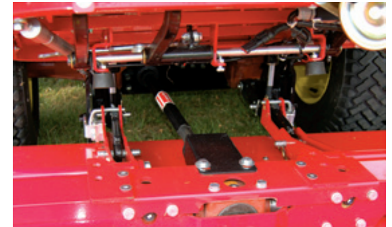
Op het oog zit het frontmaaidek aan te lichte draagarmpjes vast.
