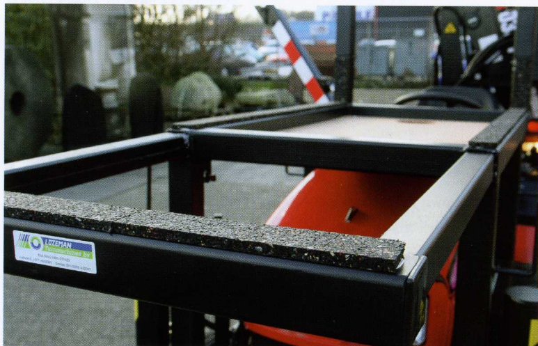
De machine is voorzien van een uitschuifbare laadbeugel voor het op de begraafplaats vervoeren van een gewicht tot vijfhonderd kilo.
