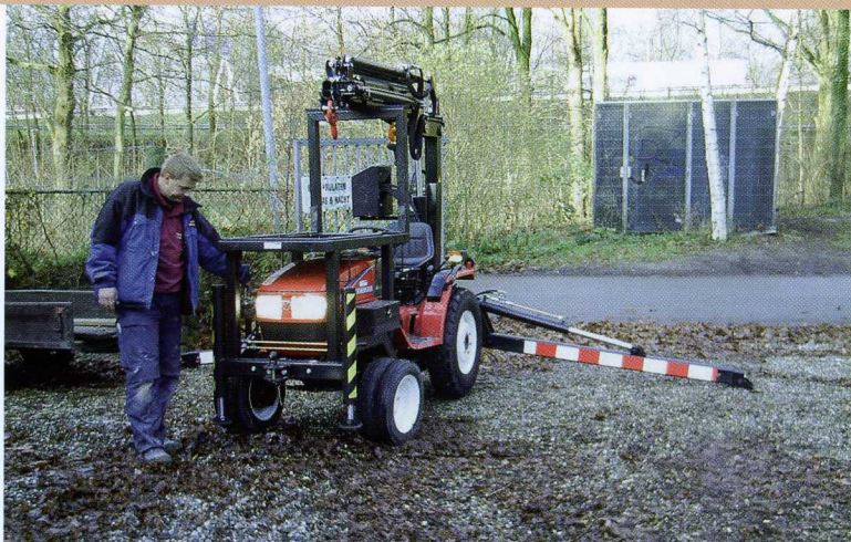
Switters-Terpstra-Woldring heeft gekozen voor dubbele voorbanden, voor een betere drukverdeling op diverse soorten ondergronden.
