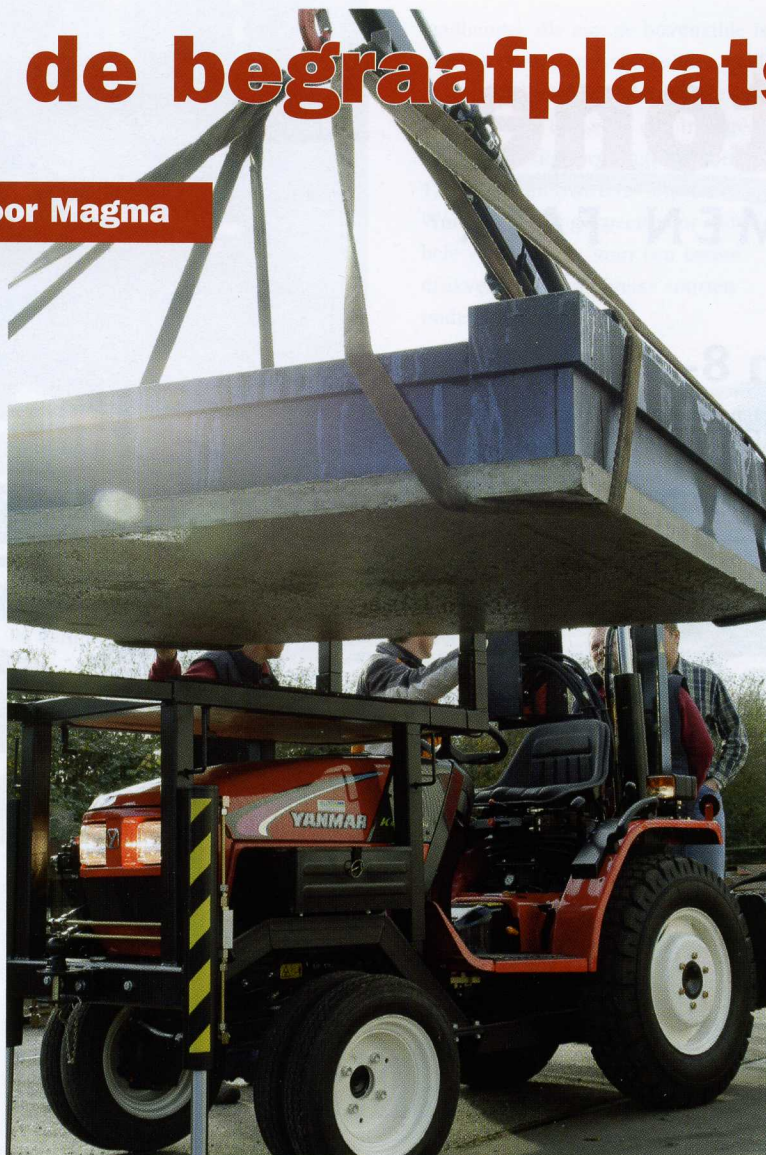
De Stone Carrier betekent voor de medewerkers een aanzienlijk verlichting bij het plaatsen en afhalen van gedenktekens.
