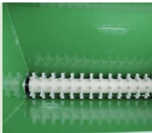
In de zaadbak zit een bezemrol over de volle breedte. Deze rol die wordt aangedreven door de achterrol zorgt voor een regelmatige uitstroom van het graszaad.
