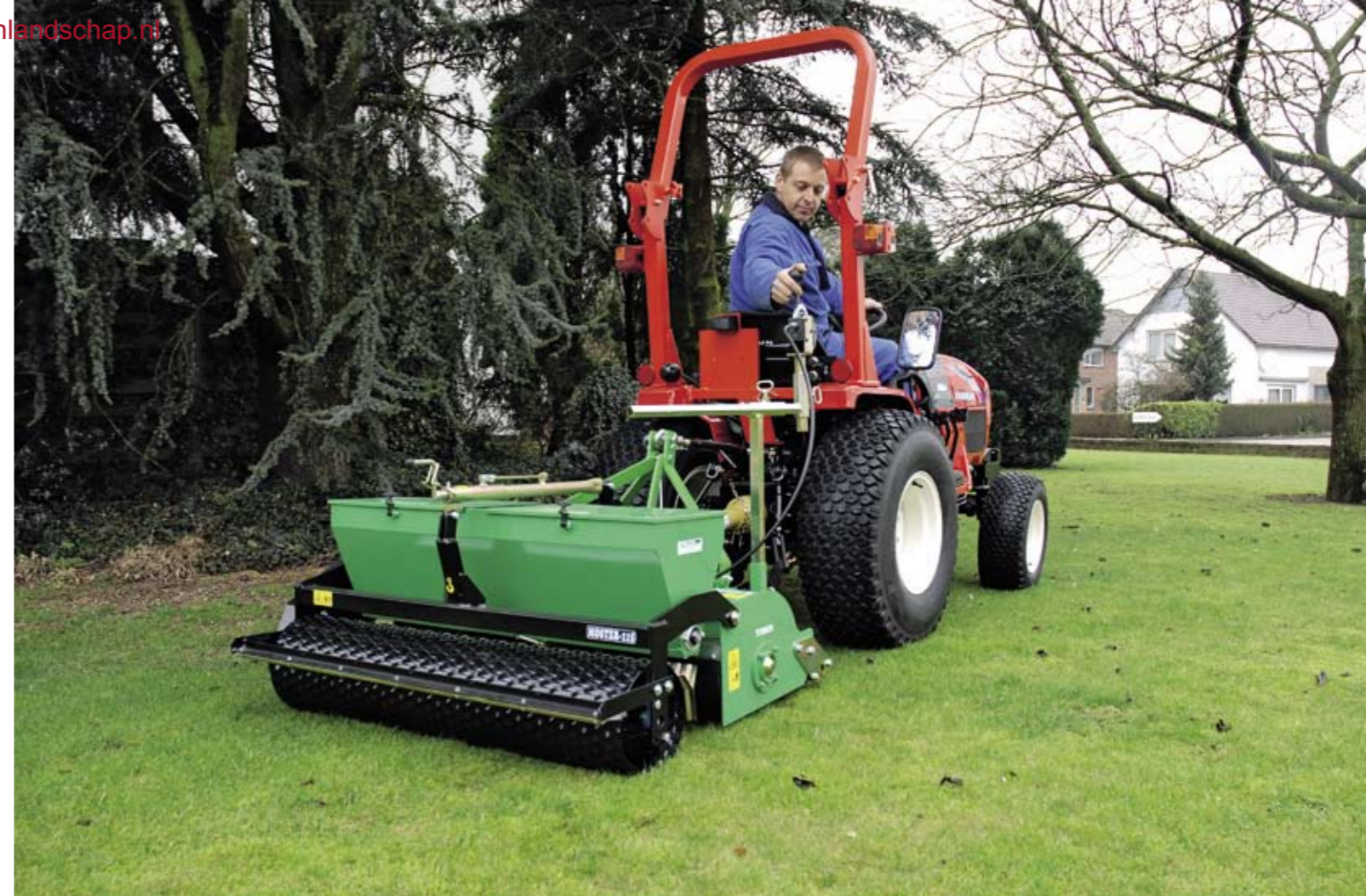
De Trer Moster 115 doorsnijdt de grasmat met messen, brengt zaad in de gemaakte sneden en dekt de sleuven daarna weer toe.
