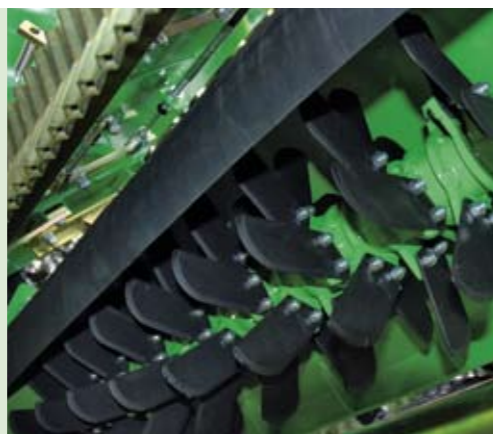
De messen zitten in een spiraalvorm om de messenas. Elke 3 cm maken twee messen samen één snede. De messen kunnen tussen 1 en 6 cm diep snijden.
