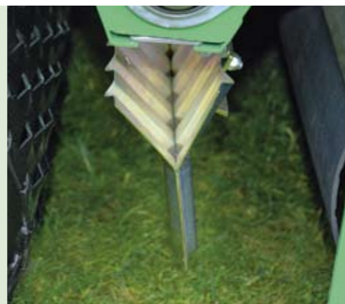
Het graszaad valt vanuit de openingen in de bak in zaai pijpen die het zaad verder geleiden naar de sneden die de messen hebben gemaakt.
