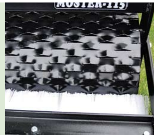
Achter de verkruiemelrol zit een borstel die de rol zo goed mogelijk schoon houdt.
